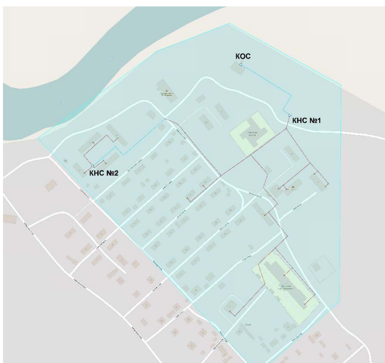
Рисунок 10-2. Размещение площадных объектов системы водоотведения
